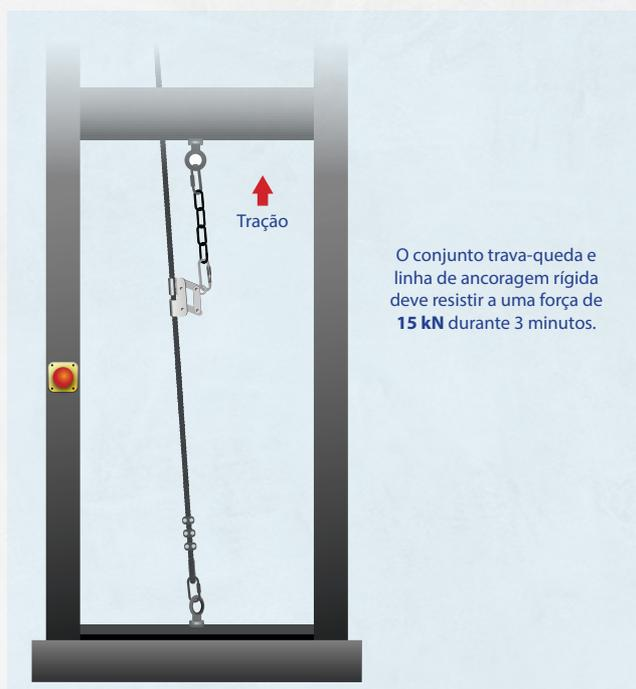
Diferentemente da norma sobre linhas flexíveis, a NBR 14627 não exige o ensaio das linhas de ancoragem separadamente. O ensaio estático é realizado com o conjunto linha de ancoragem e trava-queda.
