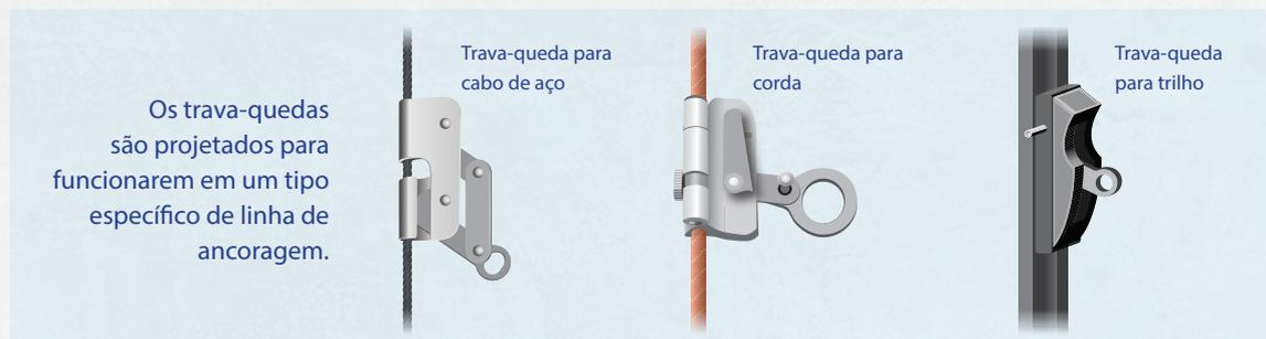
Um trava-queda deslizante é conectado a uma guia e ao cinturão de segurança tipo paraquedista do usuário. Ele deve acompanhar os movimentos do trabalhador, seja subindo ou descendo, sem interferir nesses movimentos, no entanto, caso haja a queda ele deve travar sem a necessidade do acionamento pelo usuário.
