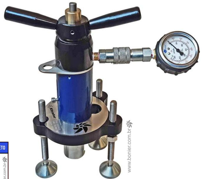
**DISPOSITIVO DE SEGURANÇA PARA REALIZAÇÃO DE TESTE DE TRAÇÃO E CONFIABILIDADE DE INSTALAÇÃO DE PONTOS DE ANCORAGEM EM FIXAÇÃO VERTICAL, HORIZONTAL OU PLANOS INCLINADOS EM CONCRETO.**
