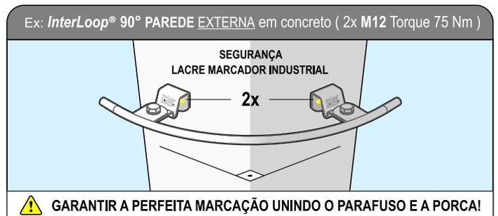
**\*COMPATIBILIDADE InterLoop® ANCORAGENS MÓVEIS LVH Loop® ProLL / LinK INOX 304 - CABO Ø8-10 mm ORIGINAL BONIER**
